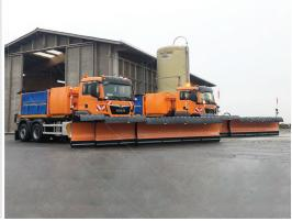
Autobahn LKW Mit Kombi-Streuautomat, Doppelteleskopschneepflug und Load Sensing Hydraulik
