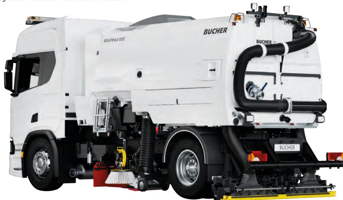
Grosses Fassungsvermögen des Kehrgutbehälters für optimierte Nutzlast mit optionalem "EasyClean".
