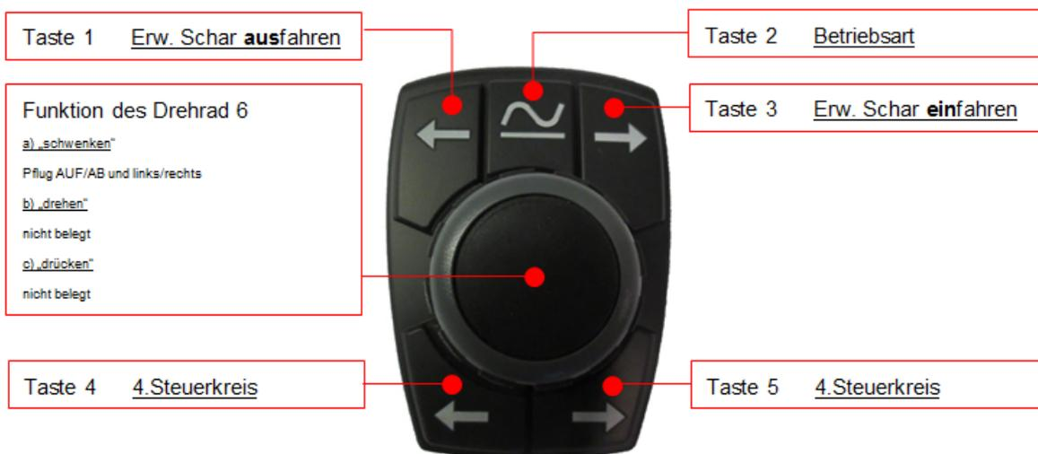
Abbildung 1: Belegung des Fahrerjoysticks
