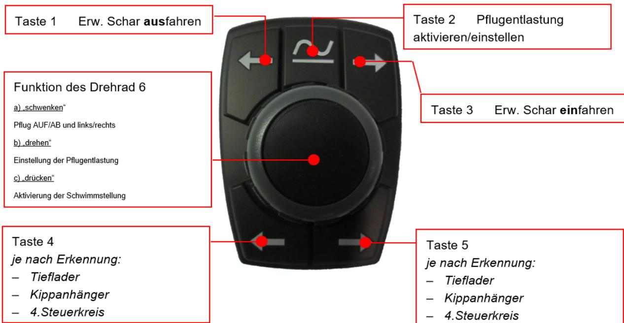
Abbildung 1: Belegung des ersten Joysticks für Fahrer
