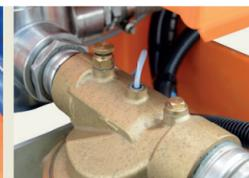
**Sistema di disinserimento pompa in caso di serbatoi vuoti**
